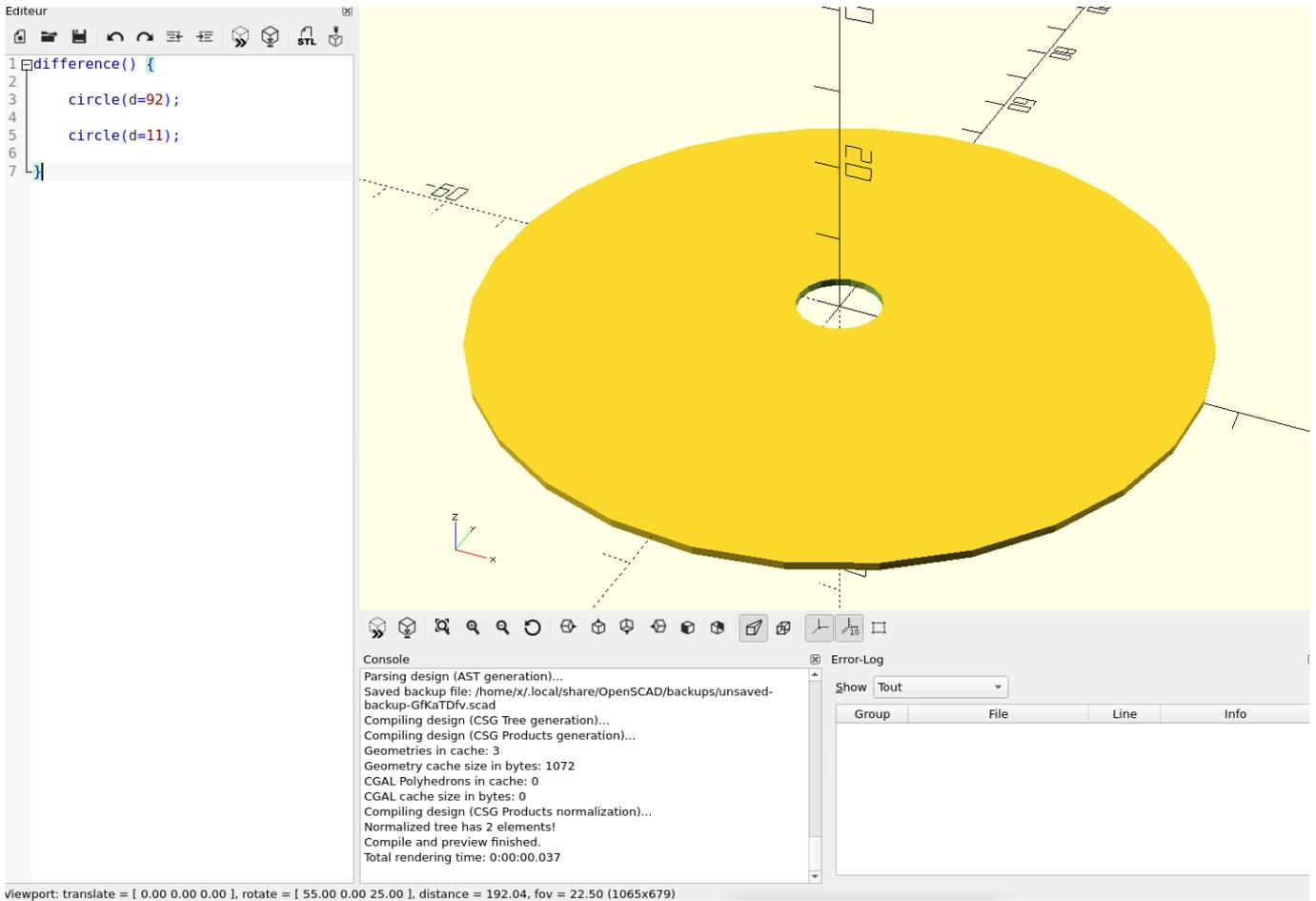
Notre prototype est d'une épaisseur d'1 millimètre. Une instruction que nous donnons dans l'éditeur d'openscad ainsi
