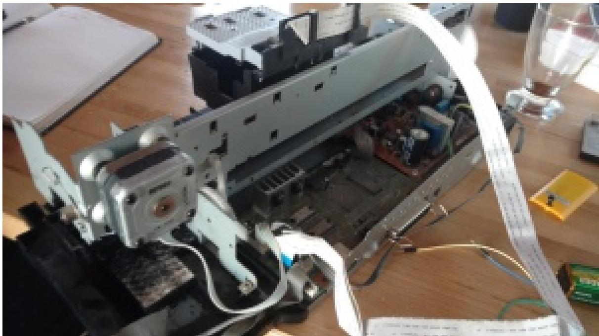
*Imprimante Epson Stylus 680 avec moteur Pas à pas Epson EM 400,4 broches (n°1 appairée avec n°2, n°3 appairée avec n°4) - 8,5 Ohm*
