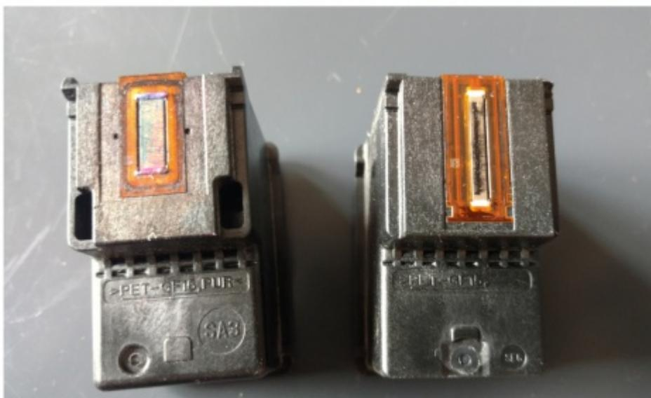
“Image de cartouches d'imprimante jet d'encre usagées. Tirées de imprimante HP deskjet 3050, Résolution d'impression max :4800 x 1200 dpi. Vitesse d'impression annoncée max : 20 (ppm). Utilisées pour un premier tests de bioimpression. Credit : XavCC, licence CC By SA 4.0”
